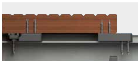
Rzut deski z boku z zamontowanym uchwytem StarterClip
