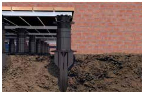
Anclaje para tierra FLEXI como fundación para la subestructura de una terraza.
