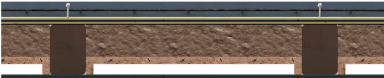
Поперечное сечение стандартного перекрытия из массива дерева
