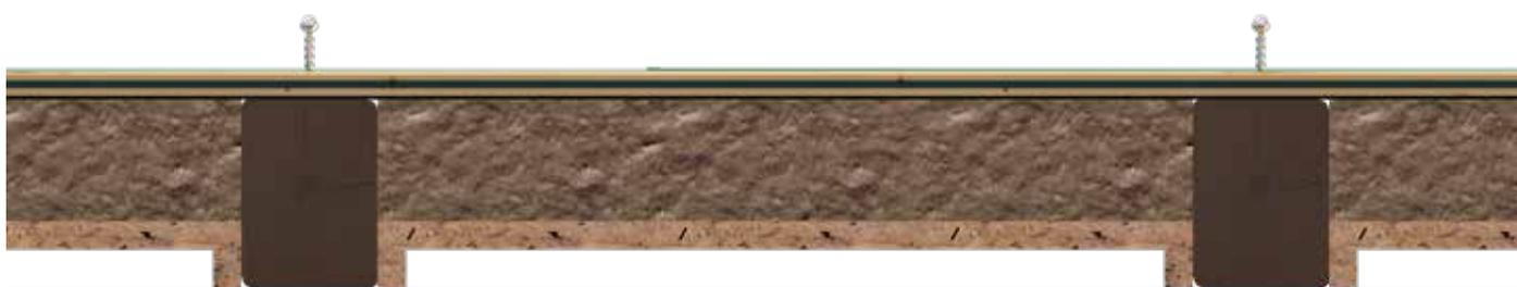
Поперечное сечение старого перекрытия с саморезами
