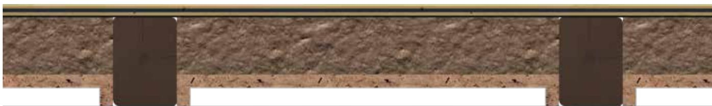
Поперечное сечение старого перекрытия с изоляцией, пленкой и опалубкой
