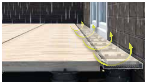
Adapter Draintec umożliwia kontrolowany odpływ wody deszczowej, ponadto w wielu punktach szczegółowych powstaje dodatkowa wentylacja tylna.
