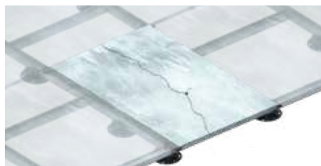
Zwiększone ryzyko pęknięcia poszczególnych płyt z powodu braku profili podpierających profile.
