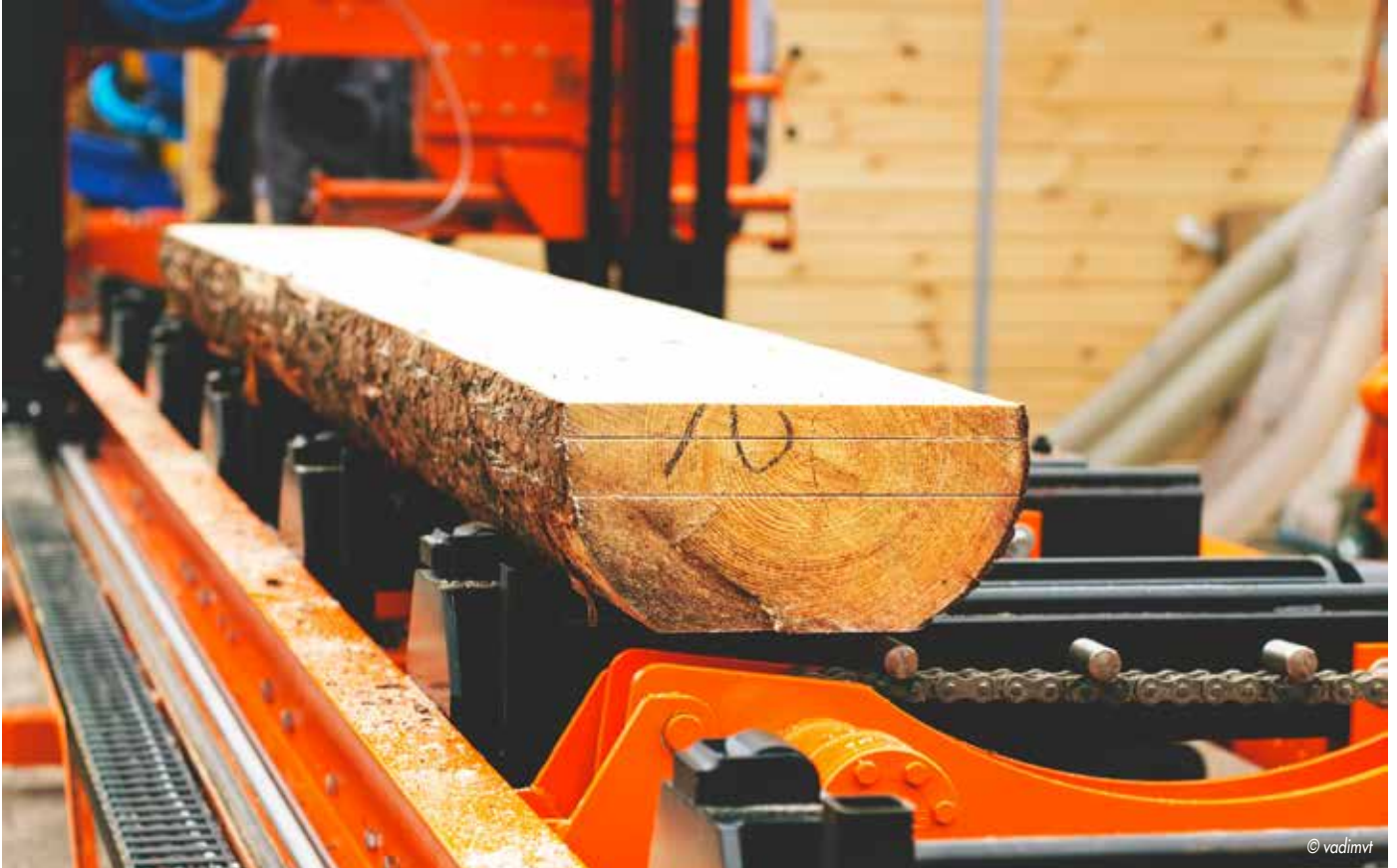
Halbrundholz in der Weiterverarbeitung zum Bauschnittholz
