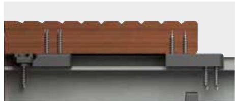
Vista lateral de una tabla con un clip Starter instalado
