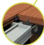
**4** Para una fijación visible: fijar las tablas una a una desde arriba con tornillos en los perfiles de aluminio.
