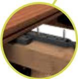
**3** Para una fijación visible: por ejemplo, fijar el listón Dista 2.0 en la subestructura de madera. A continuación, fijar las tablas desde arriba con tornillos.
