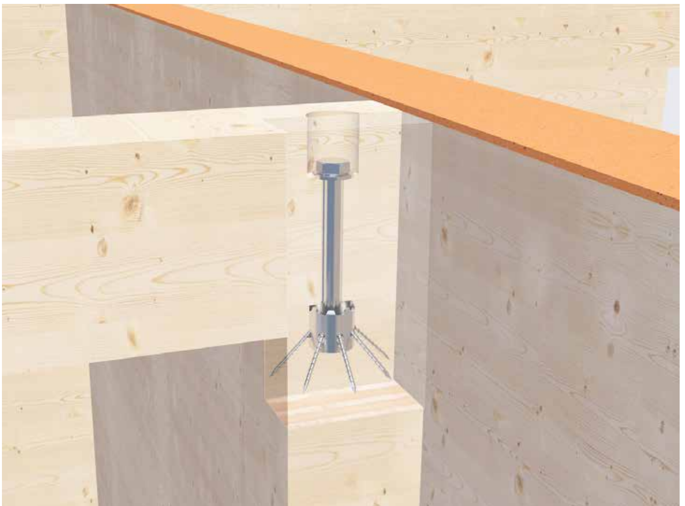
Impiego di IdeaFix per la connessione di puntelli e staffe per travetti
