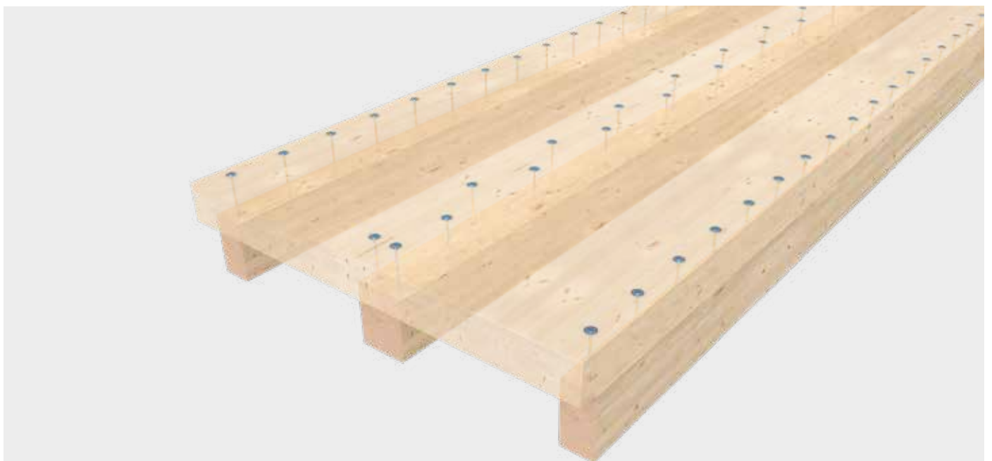
Distribuzione della pressione durante l'incollaggio a pressione di elementi in legno lamellare
