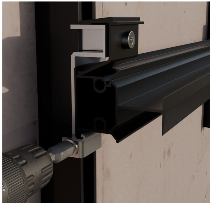
SCHRITT 8: Fassadensicherung unterhalb des Profilverbinders anlegen und mit Bighty Schraube am Basisprofil befestigen.
