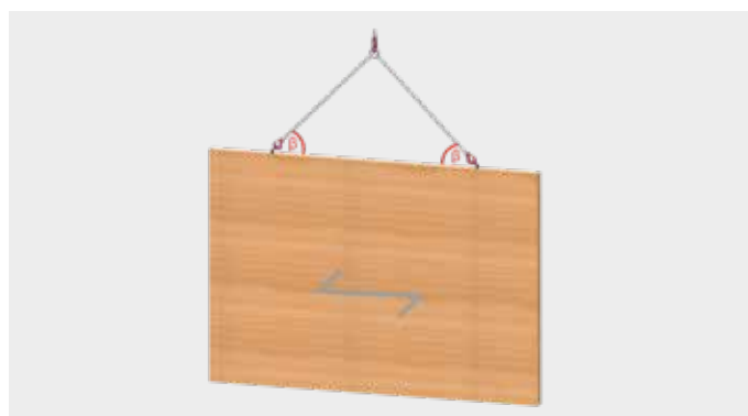
Pared o soporte de madera laminada en posición vertical, sentido de las fibras: horizontal
