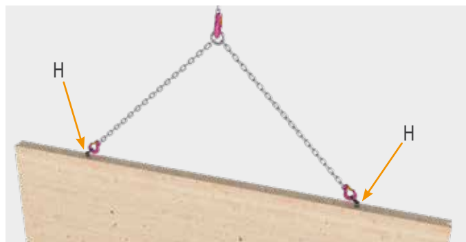
Elevación de una pared en posición vertical mediante dos anclajes de elevación montados y perno portador esférico autobloqueante (H) en el lado estrecho.
