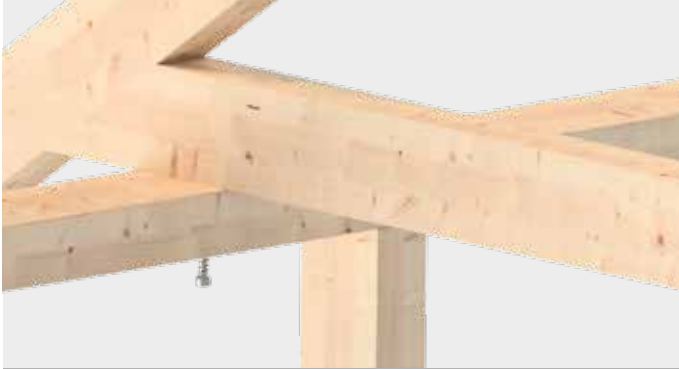
Fijación de travesaños en el caso de construcciones livianas de marcos de madera
