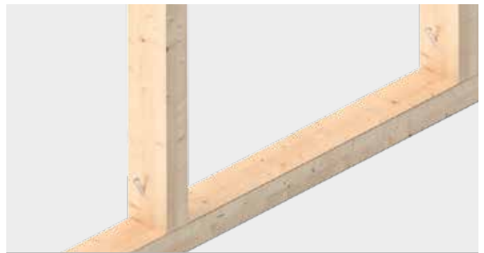
Fijación de soportes en el caso de construcciones de marcos de madera en el área de la correa inferior
