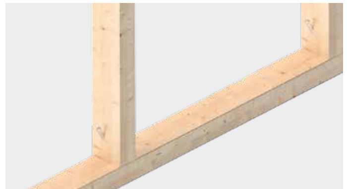
Fissaggio di supporti nelle strutture di telai in legno nelle zone dei davanzali
