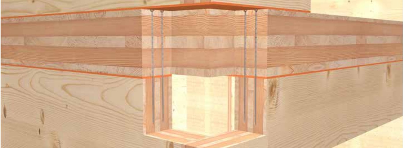
Collegamento dell'elemento a parete con l'elemento di copertura
