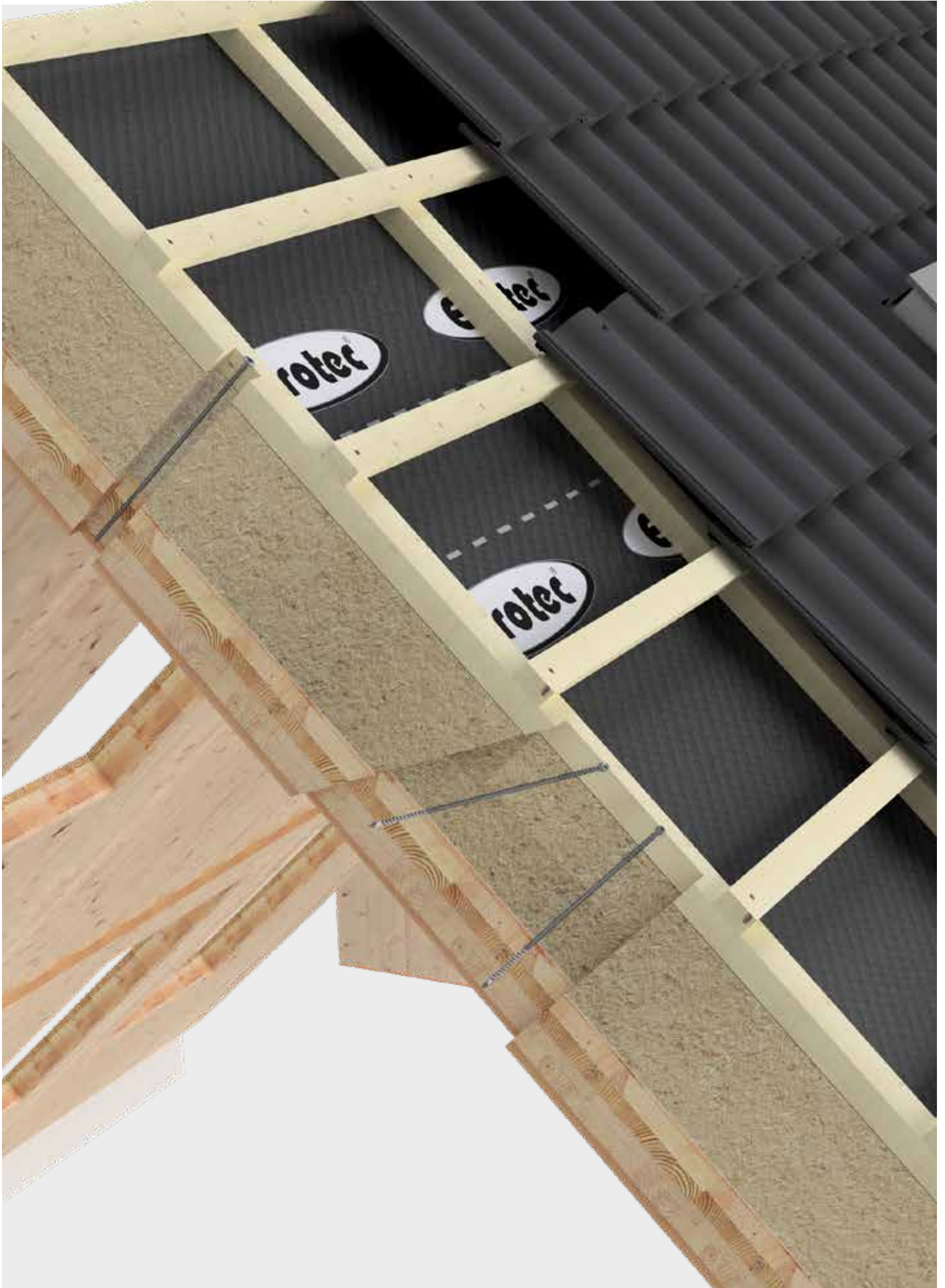
Topduo testa piatta per il fissaggio di materiali isolanti
