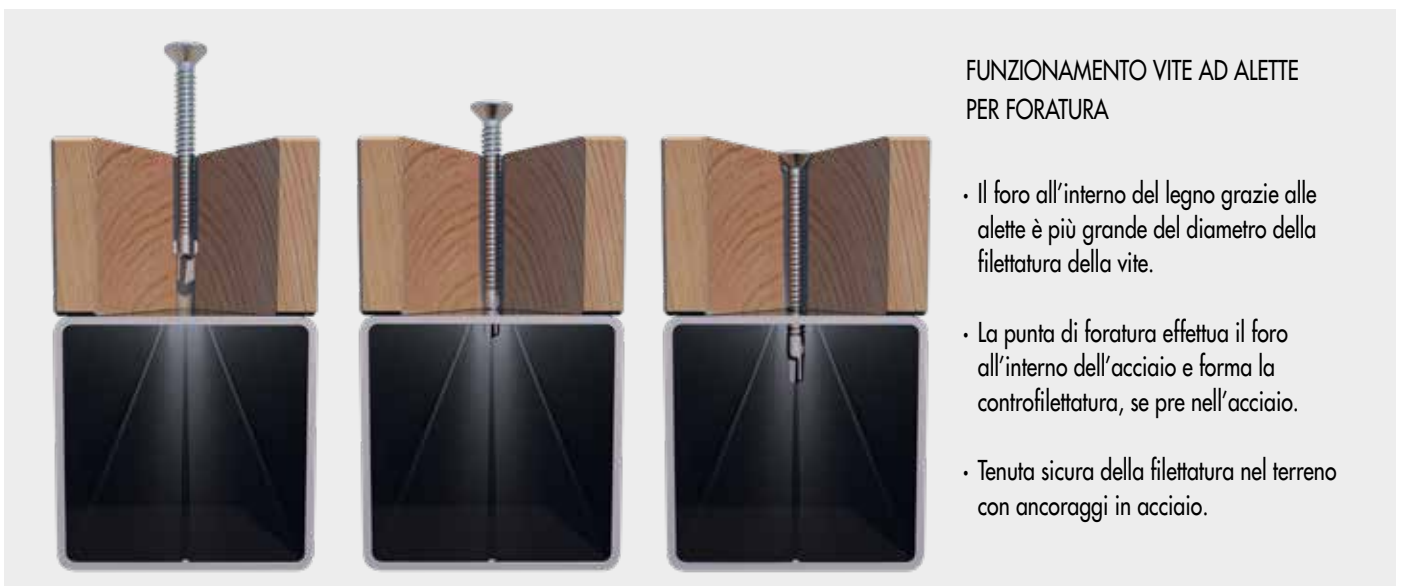
Funzionamento vite ad alette per foratura
