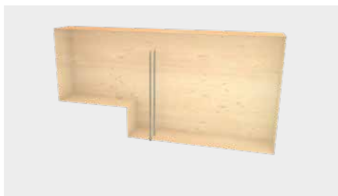
Rinforzo di travi intagliate
