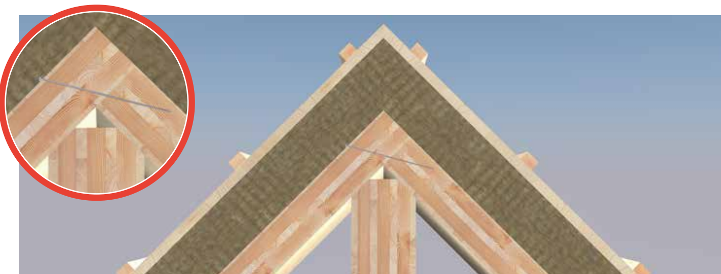
Pannelli del tetto su giunto – Avvitamento obliquo
