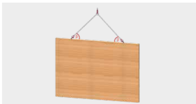
Parete o supporto BSH verticale, fibratura: verticale
