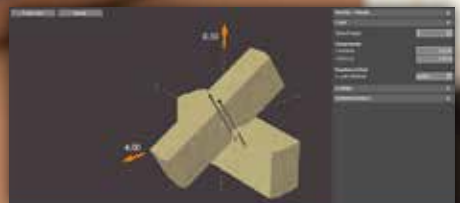
Modul für Sparren-Pfetten-Verbindungen mit Panelwistec- und KonstruX-Schrauben.
