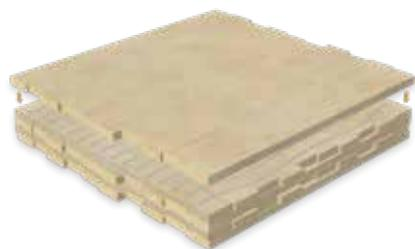
Se coloca otra capa por encima de la capa pegada, alineándola de modo que la dirección de las fibras de la nueva capa forme un ángulo de 90° con respecto a las fibras de la capa que se encuentra por debajo. Luego también se aplica pegamento a la nueva capa, y se repite el proceso hasta lograr el número deseado de capas del tablero.
