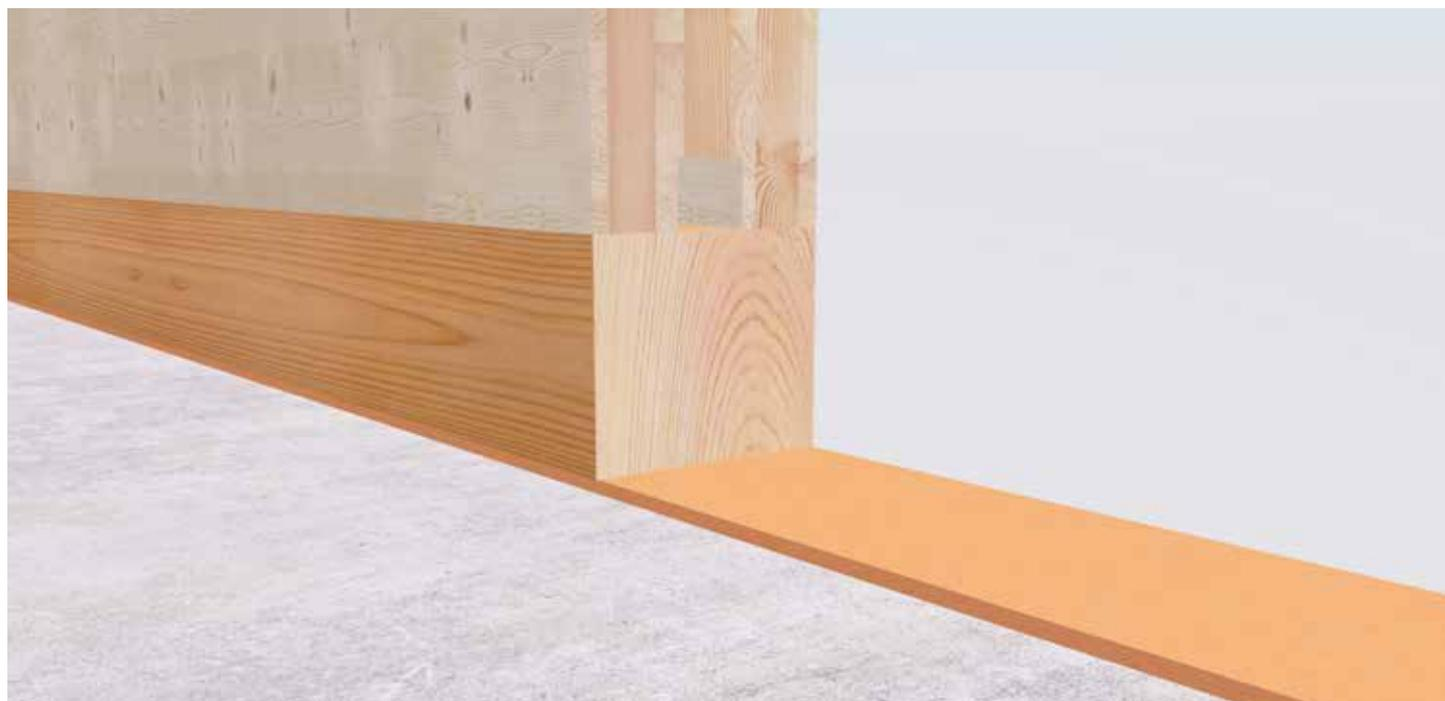
SonoTec aislamiento acústico de corcho en desacoplamiento de solera.
