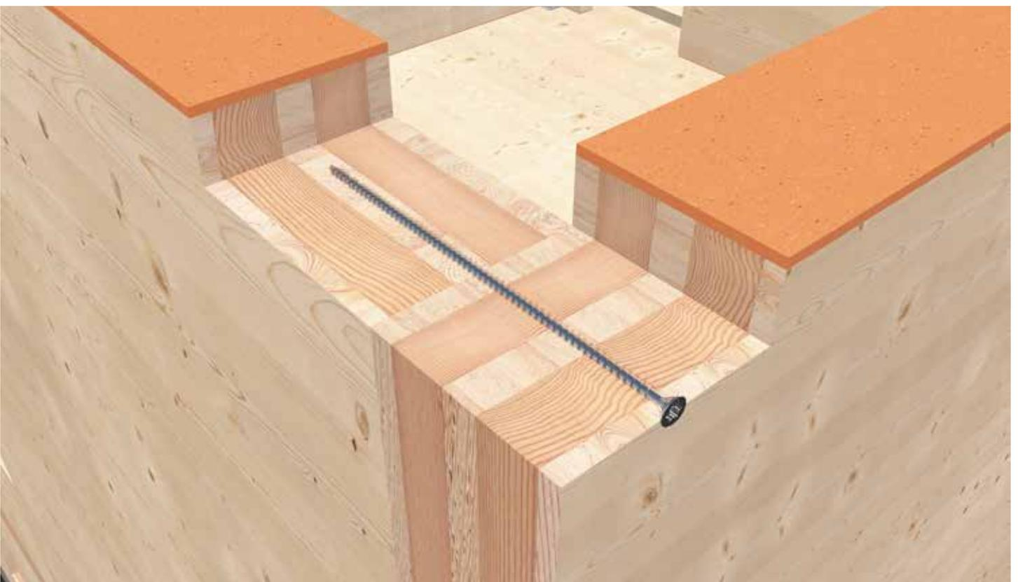
KonstruX en unión perpendicular de paredes.
