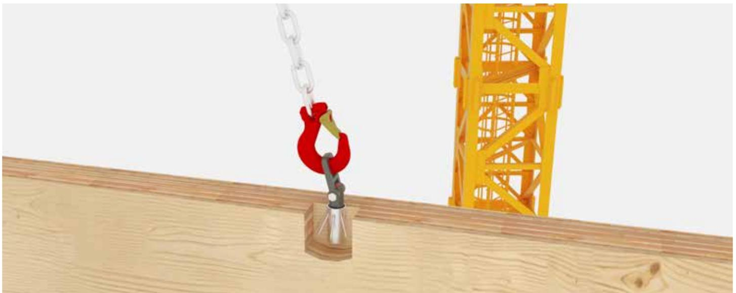
Aplicación del anclaje de elevación en el transporte de una pared de CLT.
