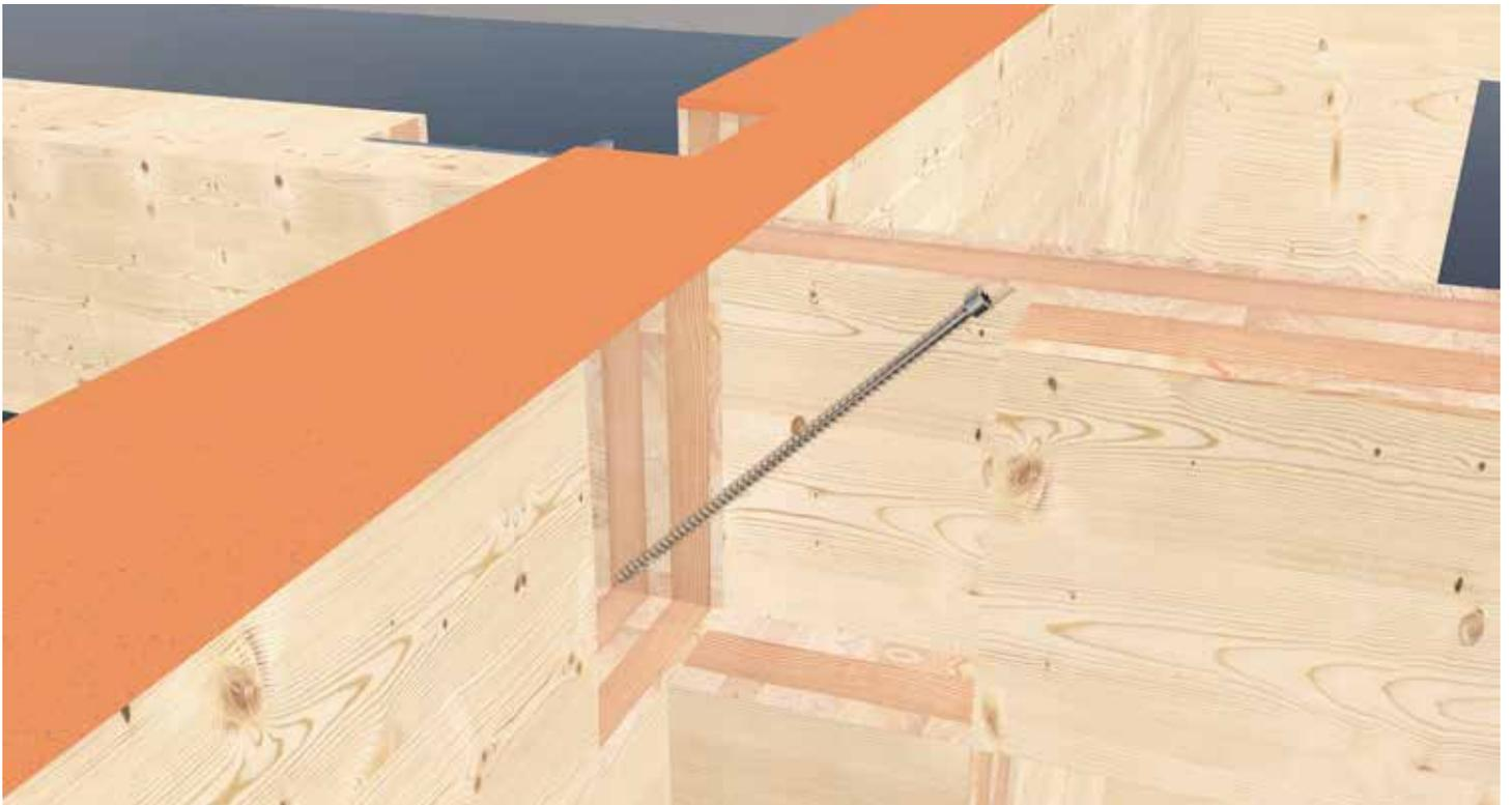
KonstruX en unión de pared y viga de techo.
