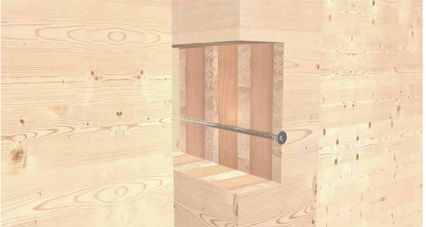
KonstruX en unión de pared con apoyo para vigüeta de techo.
