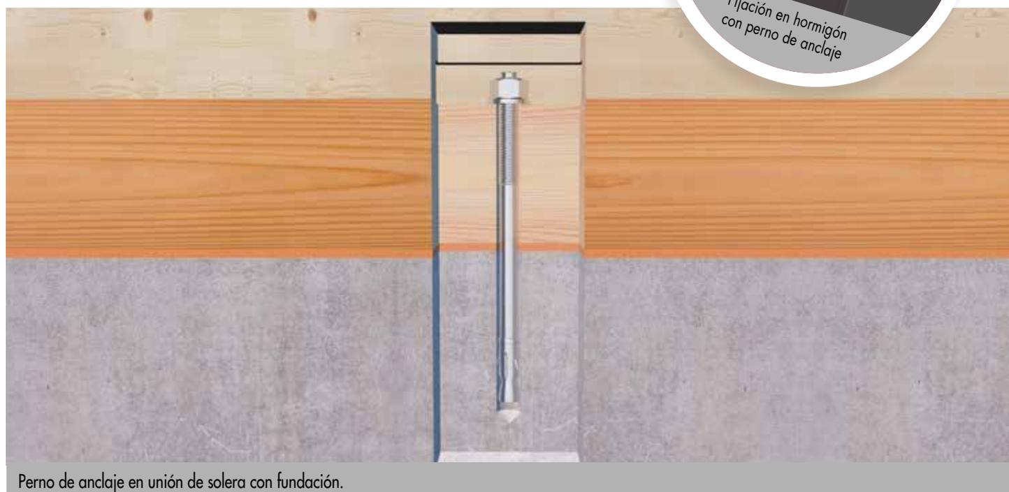
Perno de anclaje en unión de solera con fundación.
