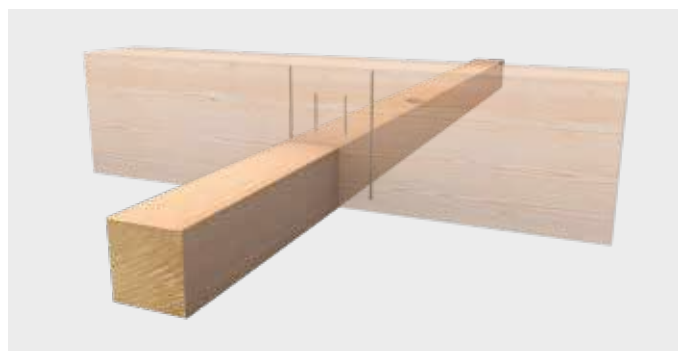
Renforcement des appuis des poutres maîtresses/poutres auxiliaires
