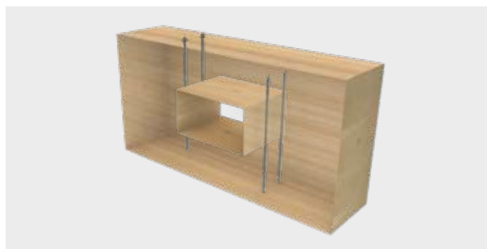
Renforcement des encoches de traverses
