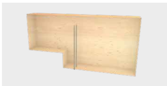
Renforcement de traverses rainurées
