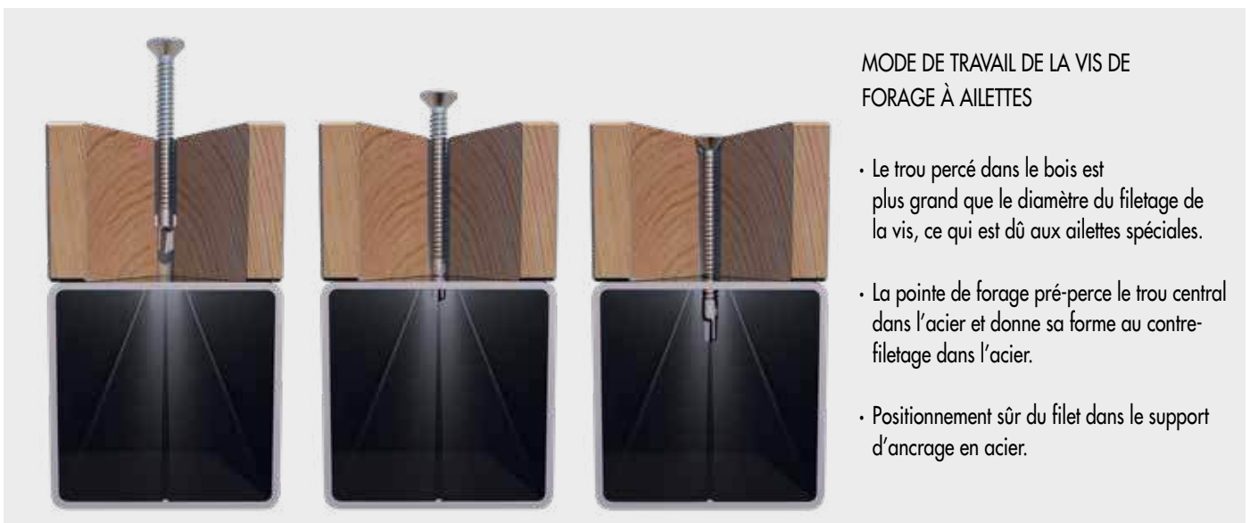
Mode de travail de la vis de forage à ailettes
