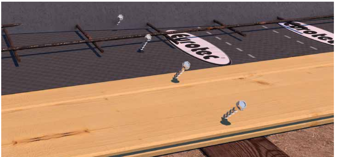
Découplage du bruit de choc et chape sur le plafond HBV
