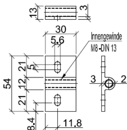
Detail Verschraubung EiSYS-P mit Alu-Profilverbinder und Standard Fassaden-T Mittelprofil:
