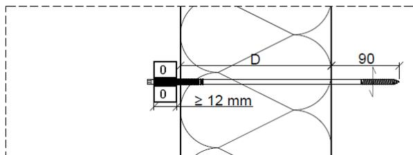
Zur Verankerung sollten mindesten 12 mm des Gewindes vom Profilverbinder auf dem Gewinde der EiSYS - Fassadenschrauben stecken. (Detail siehe Anlage 8)
