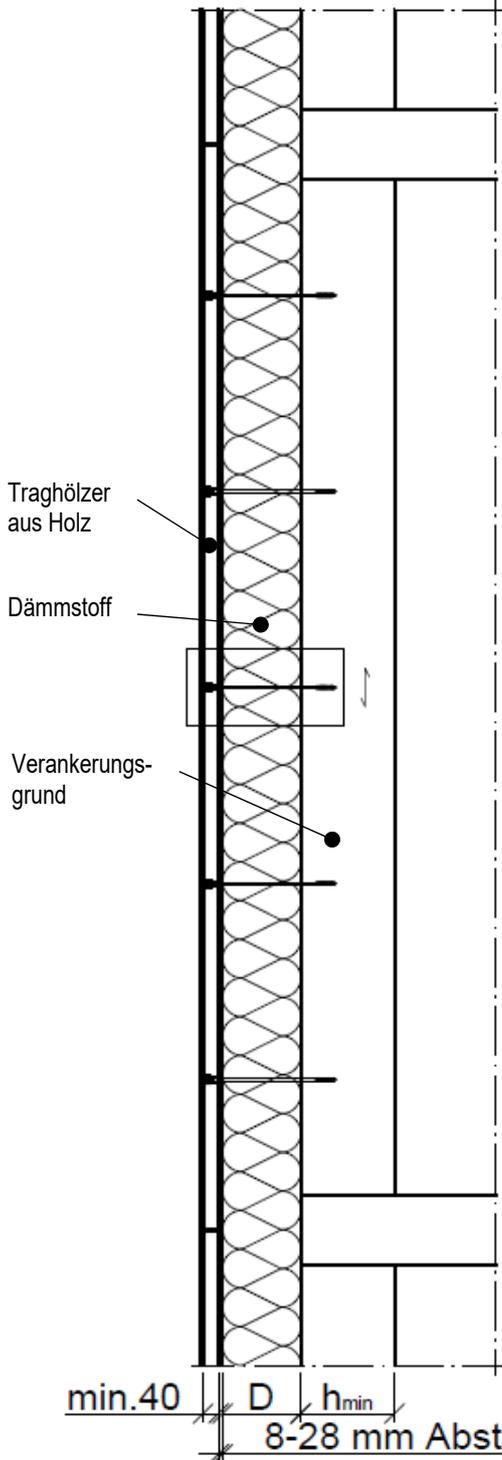
Detail horizontale Verschraubung
