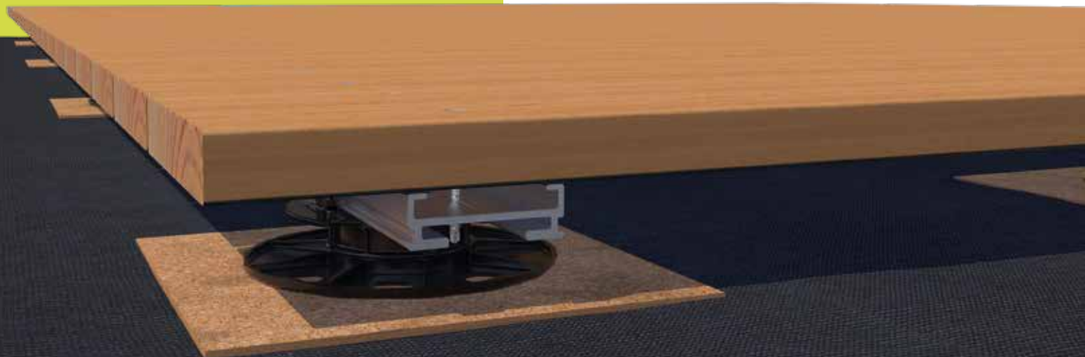
Zamocowanie widoczne przez profilowy wkręt samowierzący
