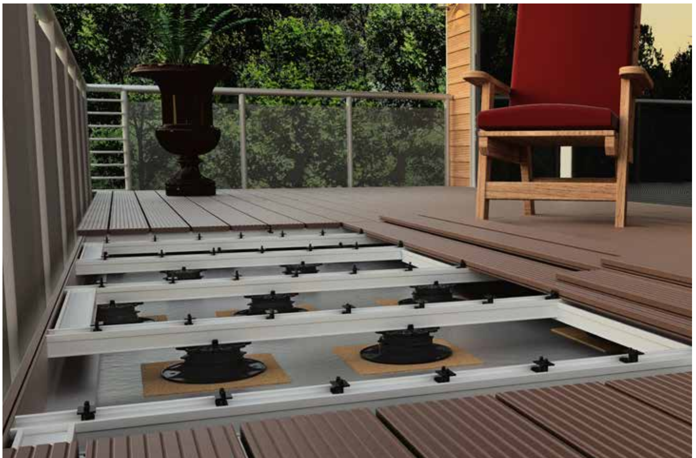
Konstrukcja nośna z nóżkami regulacyjnymi PRO, adapterem zaciskowym 60, aluminiowym profilem systemowym EVO i uchwytem systemowym Twin
