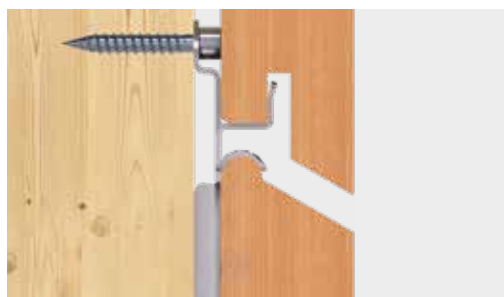
Przyłącze ściennie z rombowym zaciskiem do elewacji
