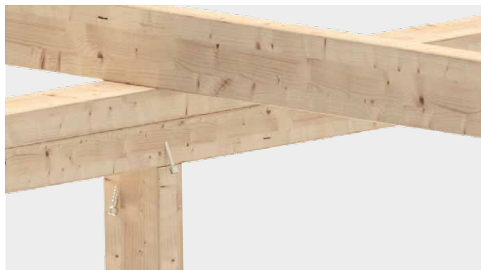
Mocowanie podpór w drewnianych konstrukcjach ramowych
