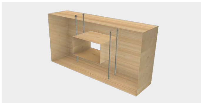
Wzmocnienie otworów w belkach
