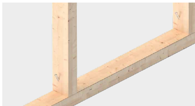
Mocowanie podpór w drewnianych konstrukcjach ramowych w obszarze podwaliny
