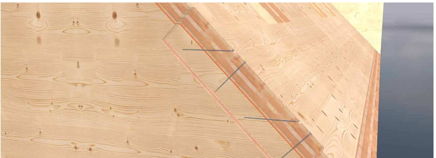
Łączenie elementu sufitowego i ściennego
