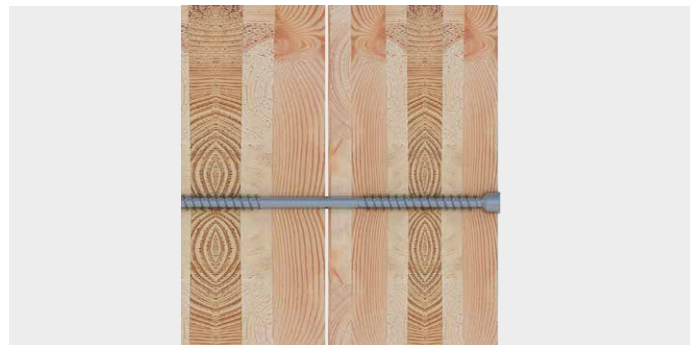
Przekrój KonstruX DUO między dwoma elementami konstrukcyjnymi
