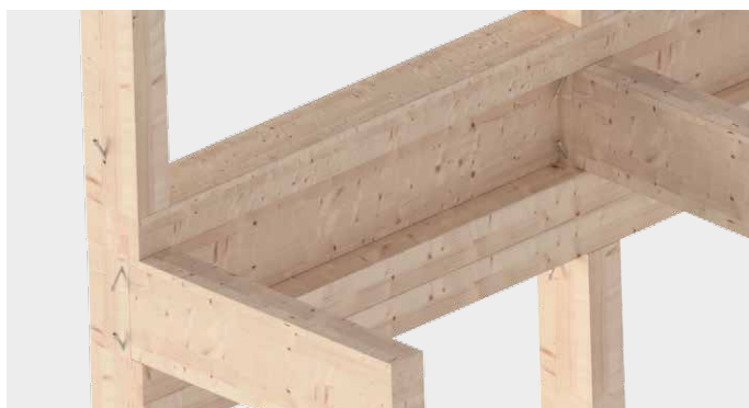
Mocowanie podpór w drewnianych konstrukcjach ramowych oraz połączeniach dźwigar główny-dźwigar pomocniczy
