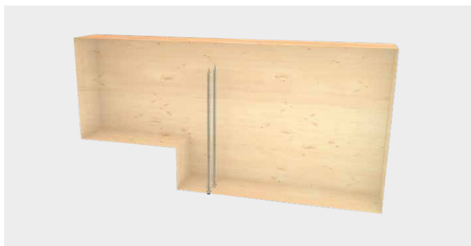
Wzmocnienie rowkowanych belek
