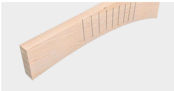
Wzmocnienie belek giętych na kształt trapezu
