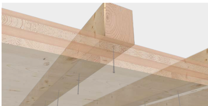
KonstruX DUO do mocowania nadciagu
