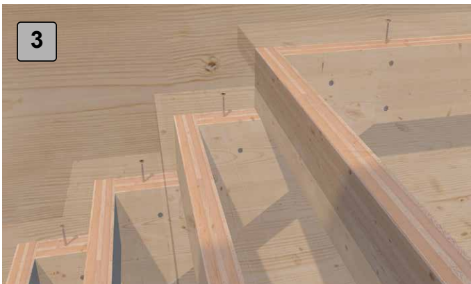
Zamontować stopnie na górze na wsporniku stopni.
