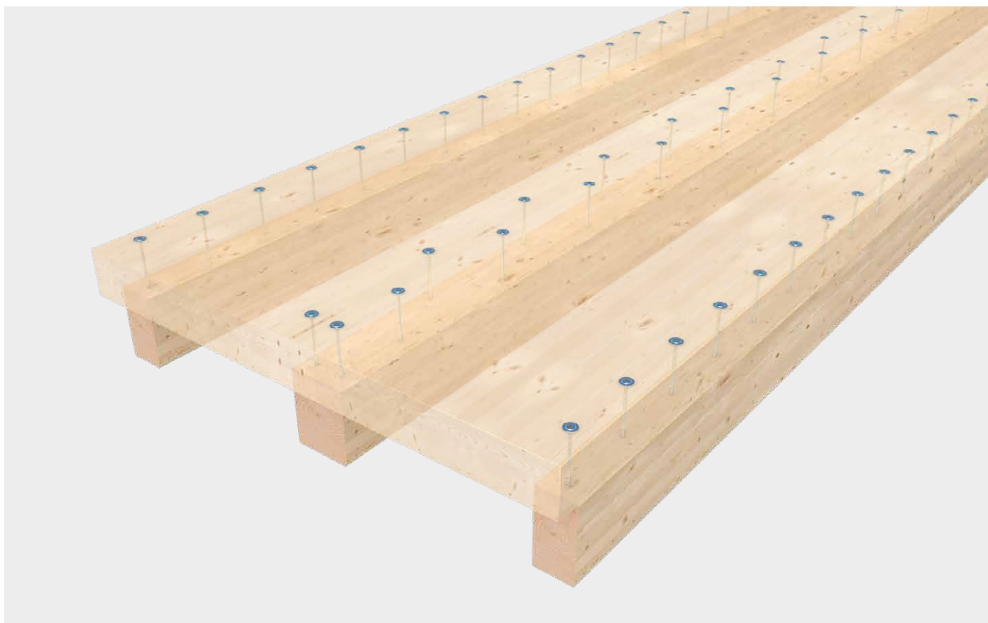
Rozdział siły nacisku podczas klejenia pod ciśnieniem z wkrętami drewnianych elementów żebrowych
