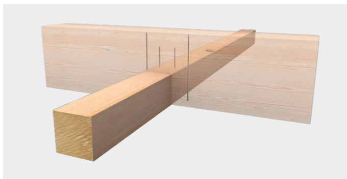
Wzmocnienie podpór dźwigarów głównych i pomocniczych
