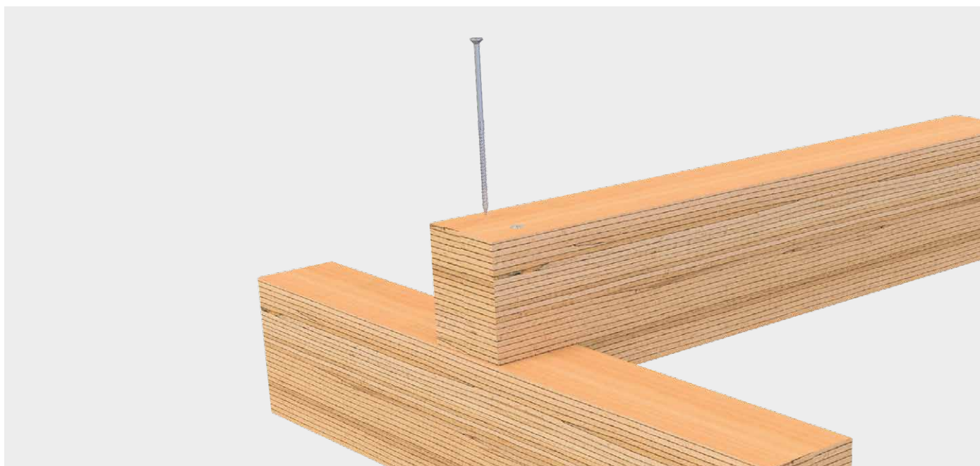
Wkręt konstrukcyjny LBS w drewnie bukowym klejonym warstwowo z fornirow
