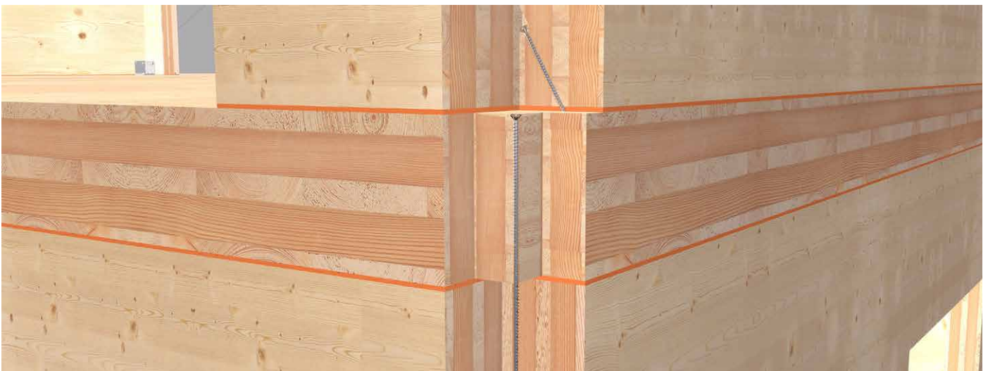
Łączenie ściany i drewnianej podłogi na piętrze
