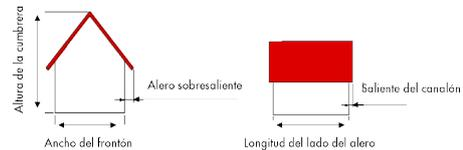
Ancho del frontón: \_\_\_\_\_ m Ancho del contralistán: \_\_\_\_\_ mm (mínimo 60 mm)
