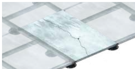
Rischio aumentato di rottura di singole lastre a causa della mancanza di profili di supporto
