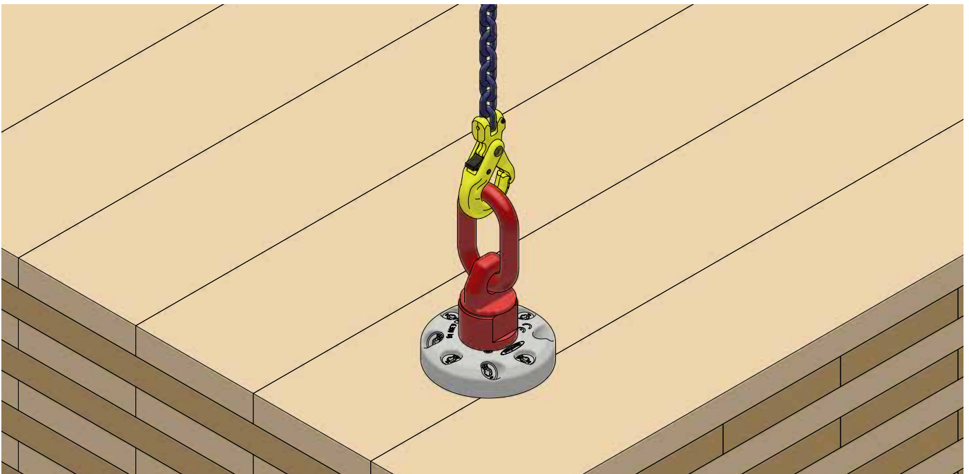
4: Aggancia il Powerring con un'angolazione precedentemente definita (v. Dati tecnici) e sollevalo.
