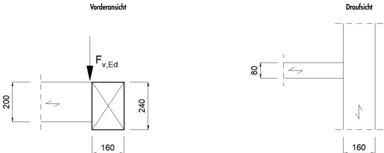
→ nach KonstruX ST Bemessungstabellen, Tragfähigkeit von Schraubenkreuzen, mit  $F_{v,Rd} \geq 9,2 \text{ kN}$
