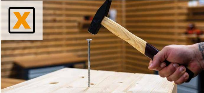
Bearbeiten Sie **den Schraubenkopf** vor der Installation nie mit einem Hammer. Dies erzeugt eine Vorspannung der Schraube und könnte auch den Kopf und die Spitze beschädigen, was die Präzision und Festigkeit der Installation beeinträchtigen könnte.
