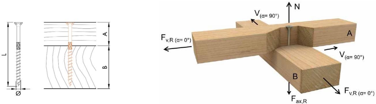
Axial- und Schertragfähigkeiten von Schrauben mit den notwendigen Mindestlängen.
