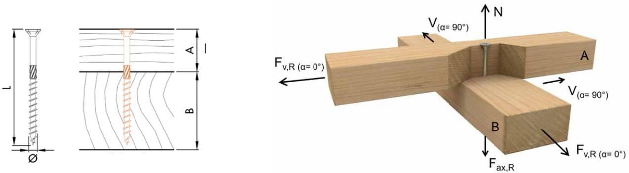
Axiale und Schertragfähigkeiten von Schrauben mit den notwendigen Mindestlängen.
