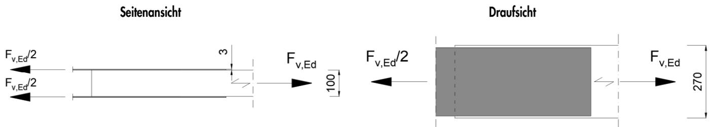
→ nach Bemessungstabellen Paneltwistec AG SK, laterale Tragfähigkeit, mit  $A = b = 100$  mm,  $t_s = 3$  mm (Dünublech)
