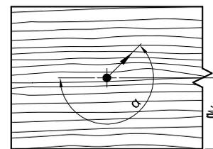
**Notizen:** Die Mindestabstände für seitlich tragende Schrauben basieren auf EN 1995:2014 unter Berücksichtigung einer Weichholzdichte von  $\rho_k \leq 420 \text{ kg/m}^3$ , wobei  $d$  = Schrauben-Nenn Durchmesser. Bei Holz-Holz-Anschlüssen müssen die Achsabstände von  $a_1$  und  $a_2$  um 1,43 erhöht werden.
