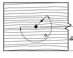
**Notizen:** Die Mindestabstände für seitlich tragende Schrauben basieren auf EN 1995:2014 unter Berücksichtigung einer Weichholzdichte von  $\rho_k \leq 420 \text{ kg/m}^3$ , wobei  $d$  = Schrauben-Nezendurchmesser. Bei Holz-Holz-Anschlüssen müssen die Achsabstände von  $a_1$  und  $a_2$  um 1,43 erhöht werden.
