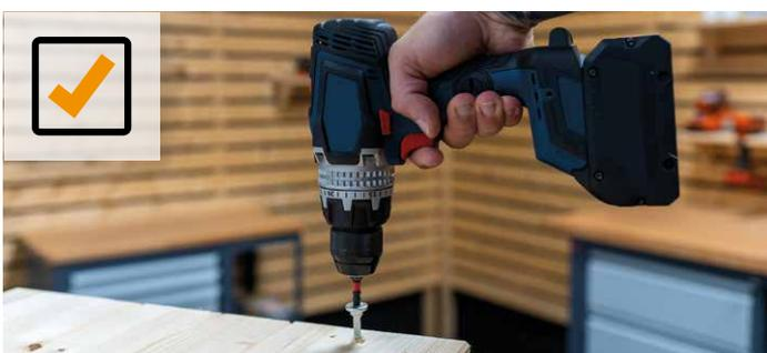
Wir empfehlen, die Installationsgeschwindigkeit zu drosseln, wenn der Kopf des Befestigers **etwa 30 mm** von der Oberfläche des Holzes entfernt ist. Dies verhindert **ein zu starkes Anziehen** der Schraube. Dies ist bei **Stahl-Holz-Anschlüssen besonders wichtig**.
