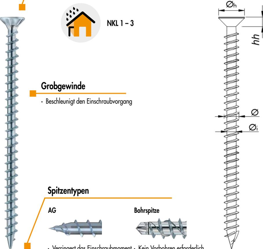
Dimensions:  $\varnothing_h$ ,  $hh$ ,  $\varnothing$ ,  $\varnothing_i$
