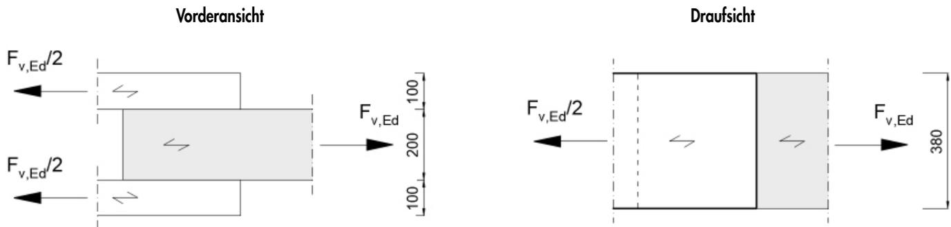
→ nach KonstruX ST ZK Bemessungstabellen, Tragfähigkeit von Scher-Zug-Schrauben, mit  $A = h_s = 100 \text{ mm}$
