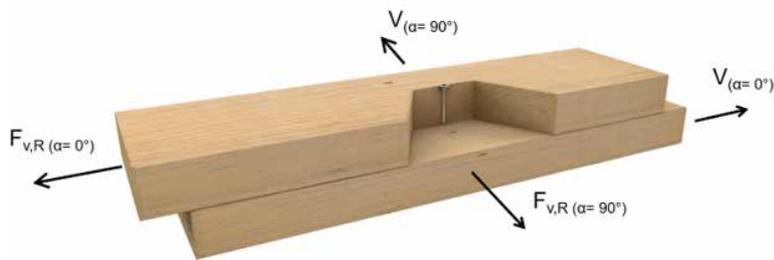
**Axiale und Schertragfähigkeiten von Schrauben mit den notwendigen Mindestlängen.**
