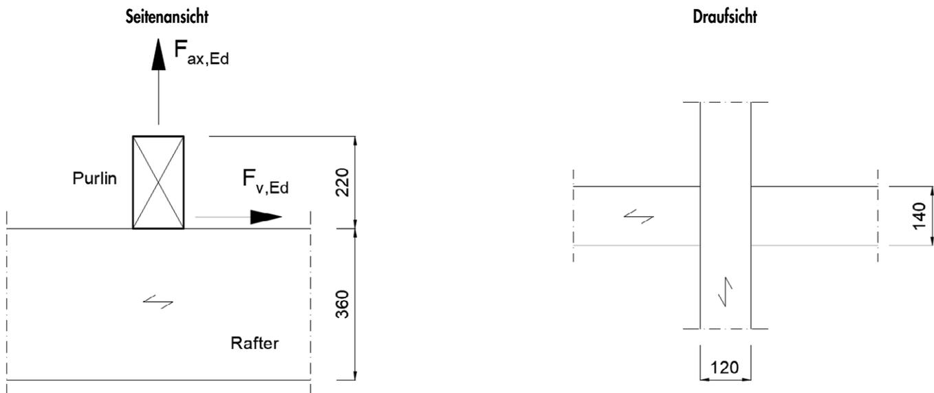
→ nach Bemessungstabellen für Paneltwistec AG SK, axiale Tragfähigkeit, mit  $A = h_p = 220 \text{ mm}$
