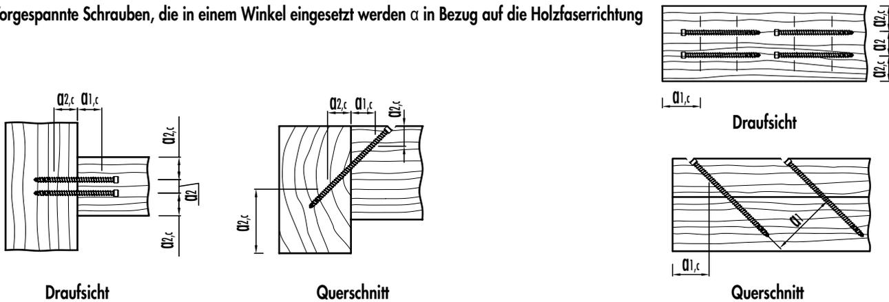
Notizen: Die Mindestabstände für axial belastete Schrauben entsprechen der ETA-11/0024 unter Berücksichtigung einer Weichholzdichte von  $\rho_k \leq 420 \text{ kg/m}^3$ , wobei d = Schraubennennendurchmesser, Mindestholzdicke  $t = 10 \cdot d$  und Mindestbreite  $w = \max [8 \cdot d; 60 \text{ mm}]$ . Bei Stahl-Holz-Anschlüssen können die Achsabstände  $a_1$  und  $a_2$  um den Faktor 0,7 verringert werden.
