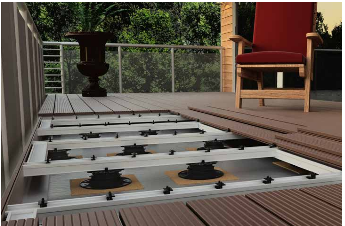
Subestructura con plots regulable PRO, adaptador click 60, sistema de perfiliería de aluminio EVO y grapa Twin
