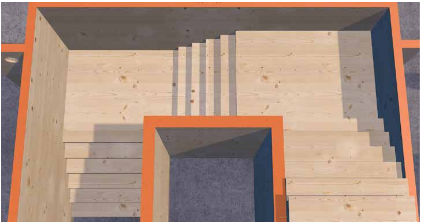
Posizionare i gradini superiori all'appoggio dei gradini.
