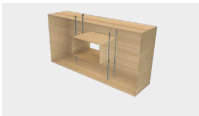
Rinforzo di aperture delle travi
