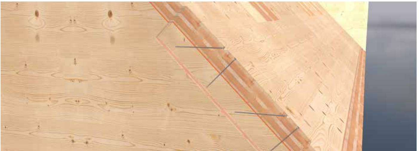
Collegamento del tetto con l'elemento a parete
