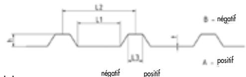
Mode de pose de la tôle trapézoïdale : →
