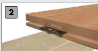
2 Fissare Eurotec Decking Clip alla sottostruttura e perforare la parte inferiore della tavola per terrazze a un angolo di 45° utilizzando il trapano da 3 mm fornito in dotazione.
