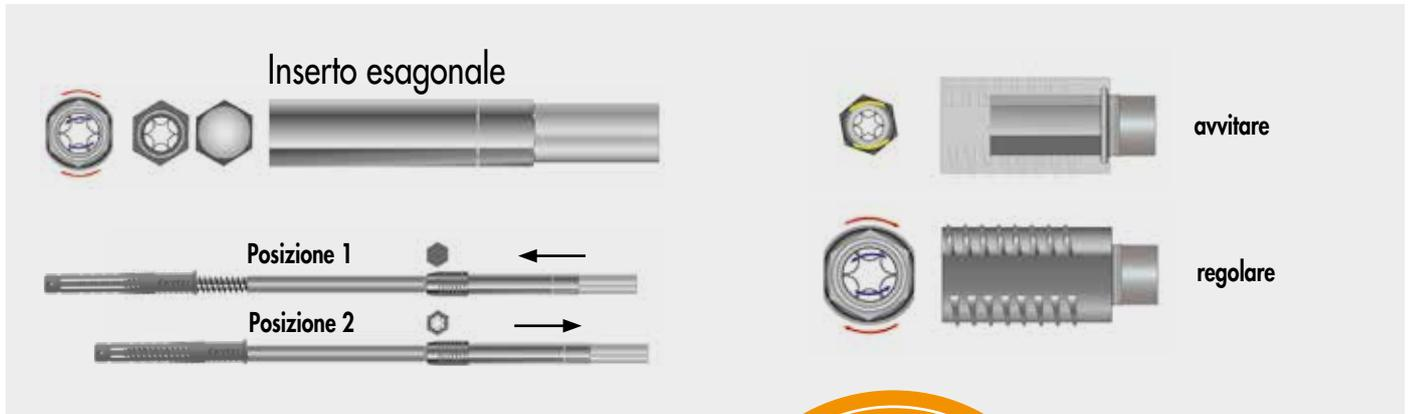
La vite EiSYS-Legno è dotata di una bussola/testa di regolazione liberamente ruotabile che consente una regolazione della distanza tra l'opera muraria e la struttura di supporto. Quale accessorio viene fornito in dotazione un inserto esagonale che viene impiegato sia per l'avvitamento della vite nel rispettivo fondo sia per la messa a punto della struttura di supporto mediante la testa di regolazione.
