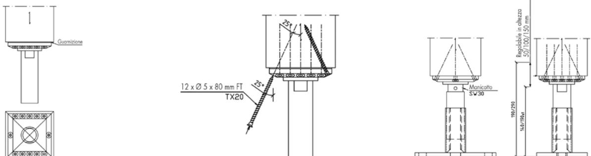
Il portapiastro PediX può essere facilmente applicato sulla sezione frontale del legno: appoggiare la guarnizione sul piede di supporto e piazzare entrambe le parti in modo centrato sulla superficie frontale del legno. Avvertenza: Per un montaggio più facile la piastra del portapiastro e la bussola di chiusura possono essere svitare.
