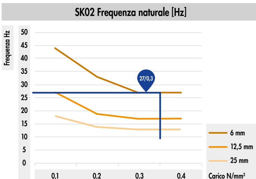
Nella prossima fase esamineremo con maggior attenzione la frequenza di interferenza. Osservando i seguenti grafici, possiamo concludere che la riduzione del suono nella gamma delle basse frequenze è peggiorata. Le basse frequenze (bassi) possono essere isolate solo da terra. Le frequenze da isolare per l'acustica degli edifici iniziano nell'intervallo di 80Hz, quindi questo è trascurabile. Se non vengono specificate frequenze di interferenza, si può ipotizzare una frequenza di 80Hz.
