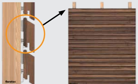
Per le aree in cui si trovano finestre, porte, giunzioni delle tavole o la fine della facciata, si possono formare punti fissi grazie alla perforazione delle Clip per facciate Rhombus. Per questo, avvitare la clip viene prima sul retro del profilo. Successivamente avvitare la clip con il bordo inferiore.
