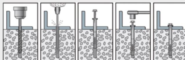
**Il nostro consiglio:** In caso di mattoni forati e blocchi forati forare in operazione di rotazione. Senza funzione di percussione! Rimuovete il residuo della foratura dal foro.
