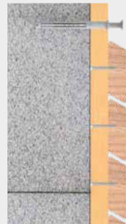
**4** Verificare la distanza con il successivo profilo a rombo, avvitare il profilo alla struttura di supporto e ripetere il passaggio **n. 4** fino a quando tutti i profili sono stati fissati.
