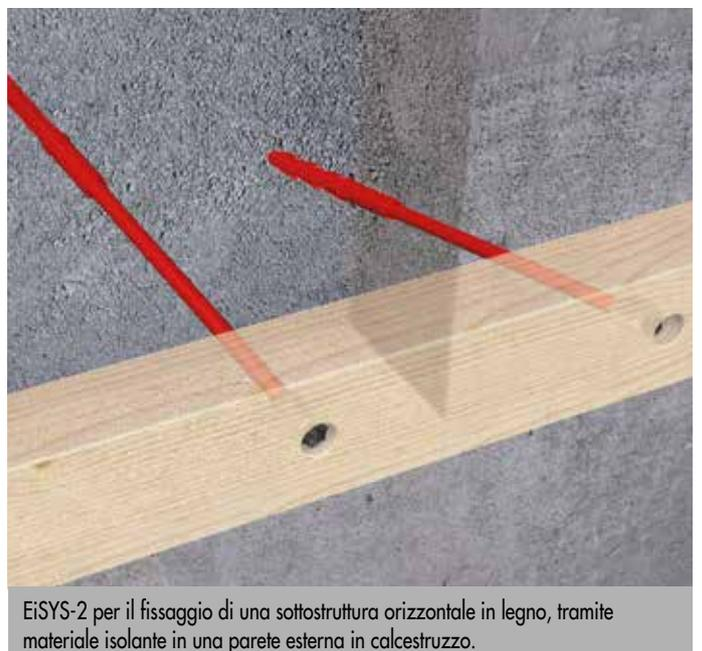
EiSYS-2 per il fissaggio di una sottostruttura orizzontale in legno, tramite materiale isolante in una parete esterna in calcestruzzo.
