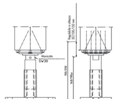
Il portapiastro PediX può essere facilmente applicato sulla sezione frontale del legno: appoggiare la guarnizione sul piede di supporto e piazzare entrambe le parti in modo centrato sulla superficie frontale del legno. Avvertenza: Per un montaggio più facile la piastra del portapiastro e la bussola di chiusura possono essere svitare.
