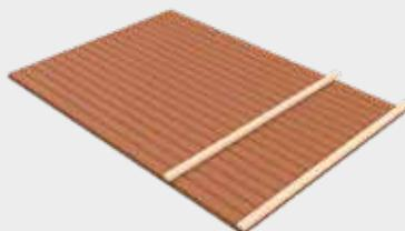
**3** Avvitare il profilo a rombo inferiore attraverso la struttura di supporto utilizzando le viti per facciate ZK.
