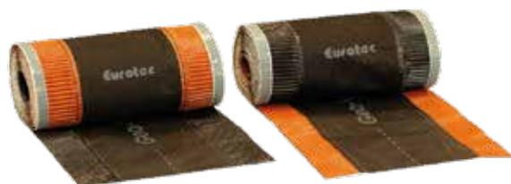
Rollfirst è realizzato in feltro PP di alta qualità con proprietà diffusive (150 g) e in lastra di alluminio plissettata. Grazie al feltro la banda assicura la ventilazione tra grondaia e First. Senza rischiare che acqua o piccoli animali possano penetrare sotto la struttura del tetto.
