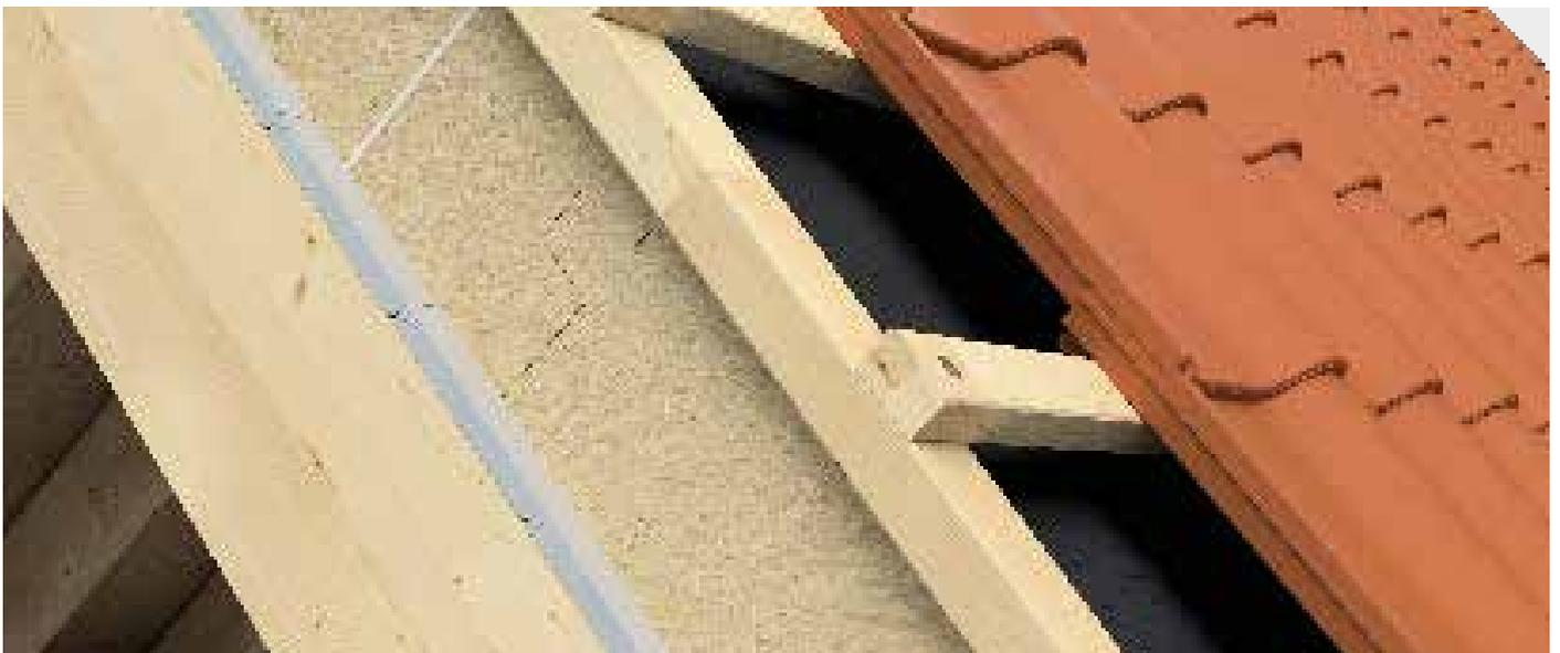
Adatto solo per materiali isolanti  $\geq 50$  kPa (resistente alla pressione)
