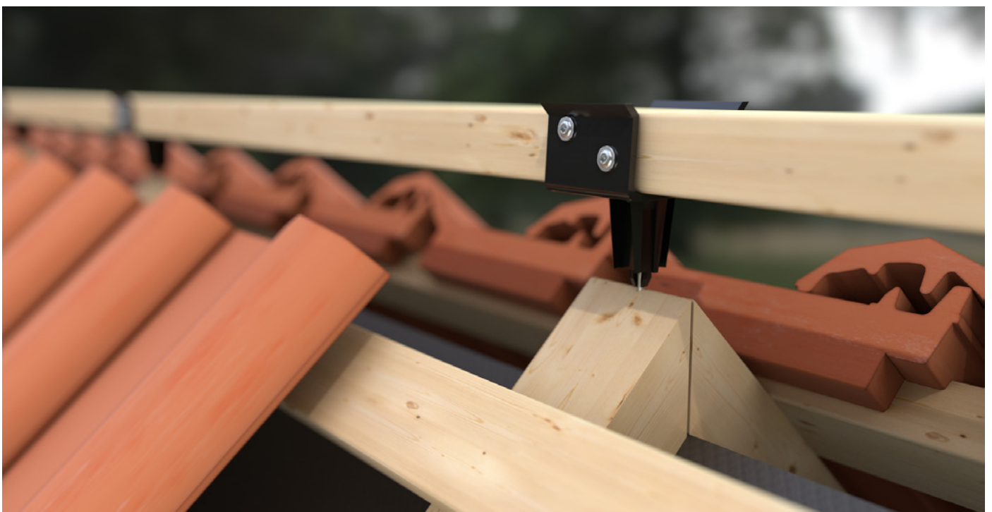
Ejemplo de montaje del soporte de rastrel de lima y cumbrera 50
