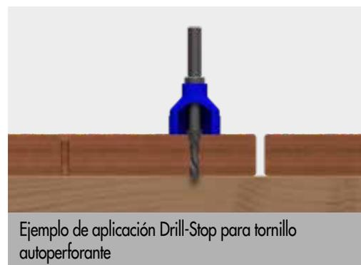
Ejemplo de aplicación Drill-Stop para tornillo autoperforante
