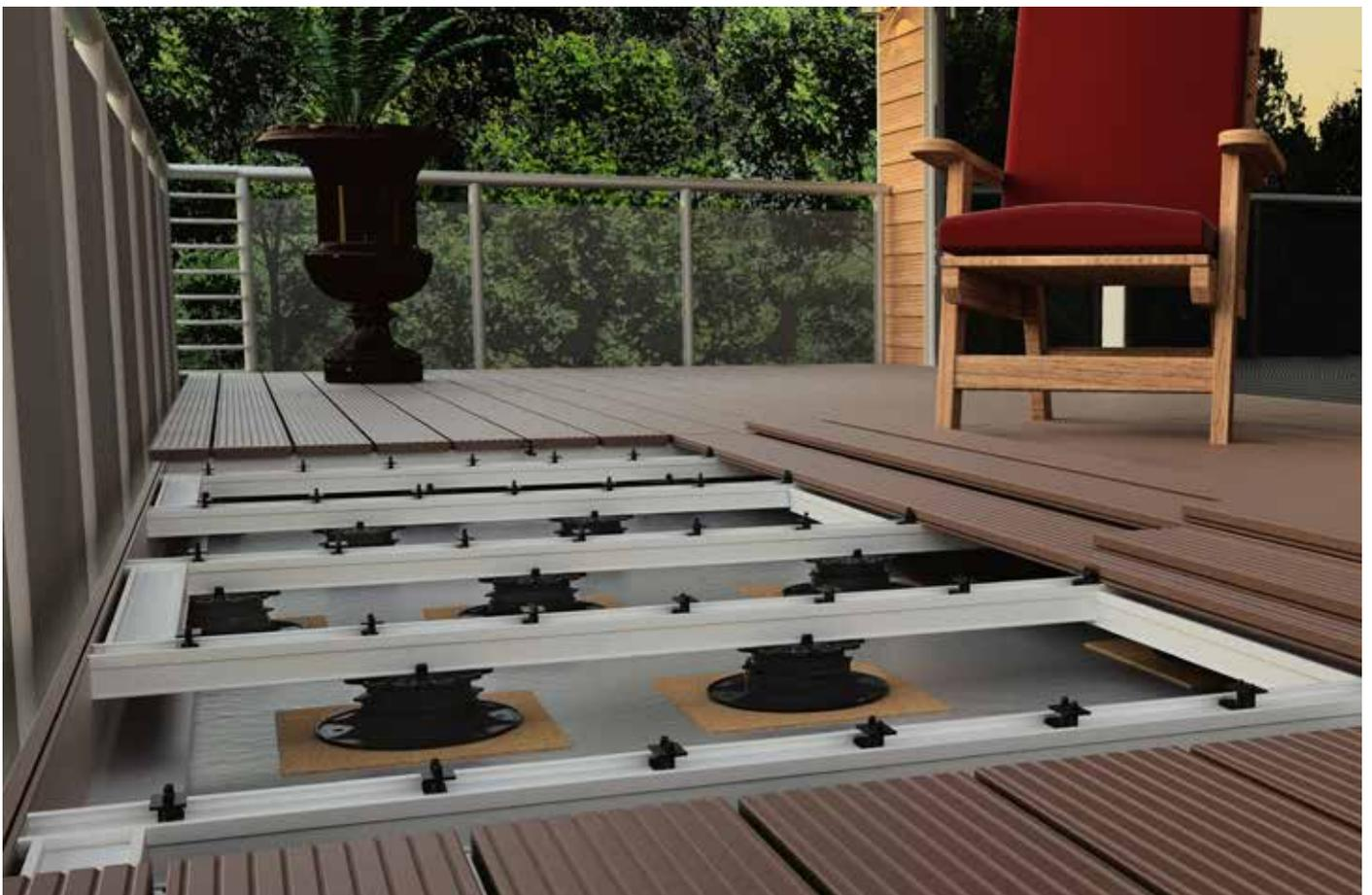
Subestructura con plots regulable PRO, adaptador click 60, sistema de perfilería de aluminio EVO y grapa Twin
