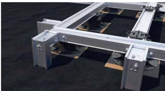
**3** Una el perfil de terminación por debajo con un corte de 45° sobre la esquina, atorníllelo a los perfiles de terminación de borde con **tornillos auto perforantes BiGHTY** y fíjelo con un **conector angular EVO**.
