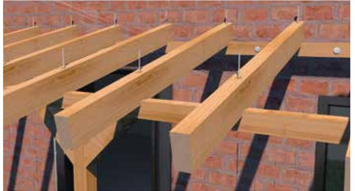
**5** El entablado de madera se coloca hacia la fachada de la casa, comenzando desde abajo, y se atornilla a las vigas del techo con tornillos **Panelwistec cabeza avellanada**.
