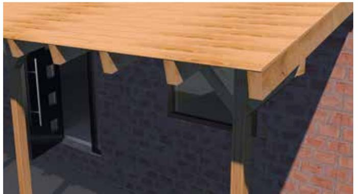
**6** En nuestro ejemplo, el tejado se realiza con teja asfáltica, listones de remate laterales, un perfil de goteo y el canalón, incluyendo los soportes.
