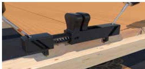
La Drill Tool 50X sobre un panel de madera con una broca escalonada 50X y el tornillo para terrazas 50X.
