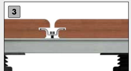
3 Inserte los demás Clip-V y atornillelos levemente. Los Clips-V colocados anterior pueden ahora fijarse firmemente. ¡Asegúrese de que el torque de atornillado esté configurado correctamente!
