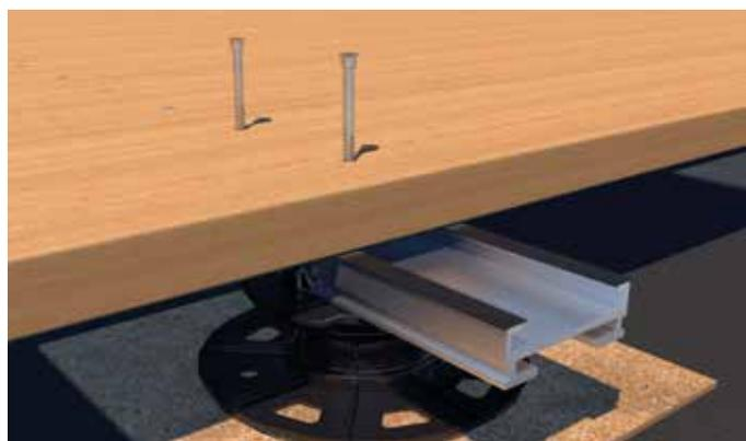
Fijación a la vista utilizando tornillos autoperforantes para perfiles
