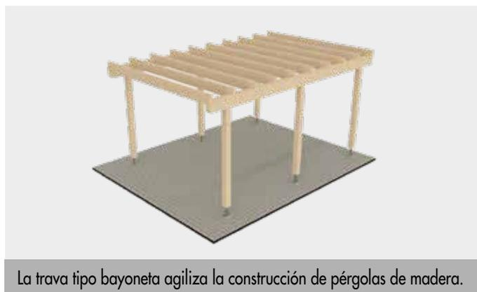
La trava tipo bayoneta agiliza la construcción de pérgolas de madera.
