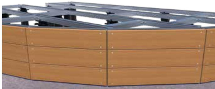
**6** Instale el entablonado de terrazas superior con tornillos auto perforantes para perfiles.
