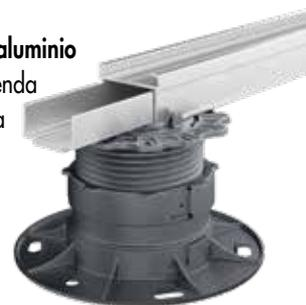
**5** Mediante los **conectores de esquina EVO** monte los travesaños para el refuerzo transversal de la subestructura.
