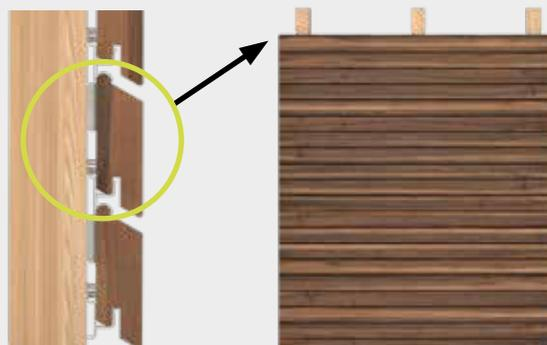
Para áreas donde se ubican ventanas, puertas, juntas de entarimado o el final de la fachada, se pueden crear puntos fijos gracias a los agujeros prefabricados en los Clips Rhombus. Para lograr esto, el clip se atornilla primero en la parte posterior del perfil, para luego atornillarse a la subestructura.
