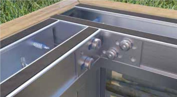
**12** Las tablas de la terraza se colocan paralelas a la fachada de la casa. Se inicia la colocación con la primera tabla junto a la fachada de la casa. En nuestro ejemplo, hemos elegido una fijación a la vista y atornillado las tablas de la tarima al **sistema de perfilería de aluminio EVO** con tornillos autoperforantes para perfiles de Eurotec. Como herramientas, recomendamos el avellanador **drill-stop**, los **separadores** y el **sargento**.
