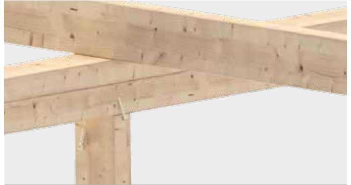
Fijación de soportes en el caso de construcciones de marcos de madera
