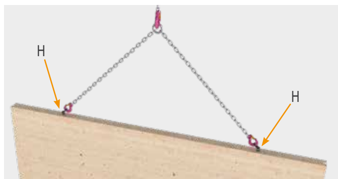
Elevación de una pared en posición vertical mediante dos anclajes de elevación Mini montados y perno portador esférico autobloqueante (H) en el lado estrecho.
