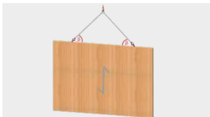
Pared o soporte de madera laminada en posición vertical, sentido de las fibras: vertical
