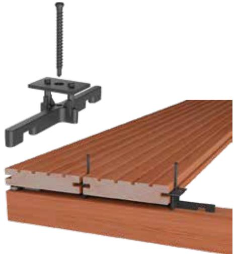
Der T-Stick auf einer Holzunterkonstruktion mit Verschraubungen
