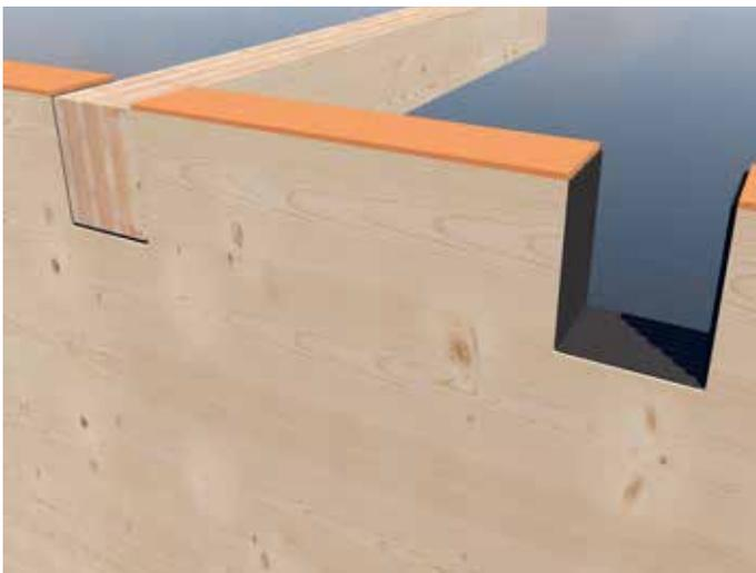
Application du profilé de découplage EPDM Silent sous poutres pour l'isolation acoustique entre les composants en bois.
