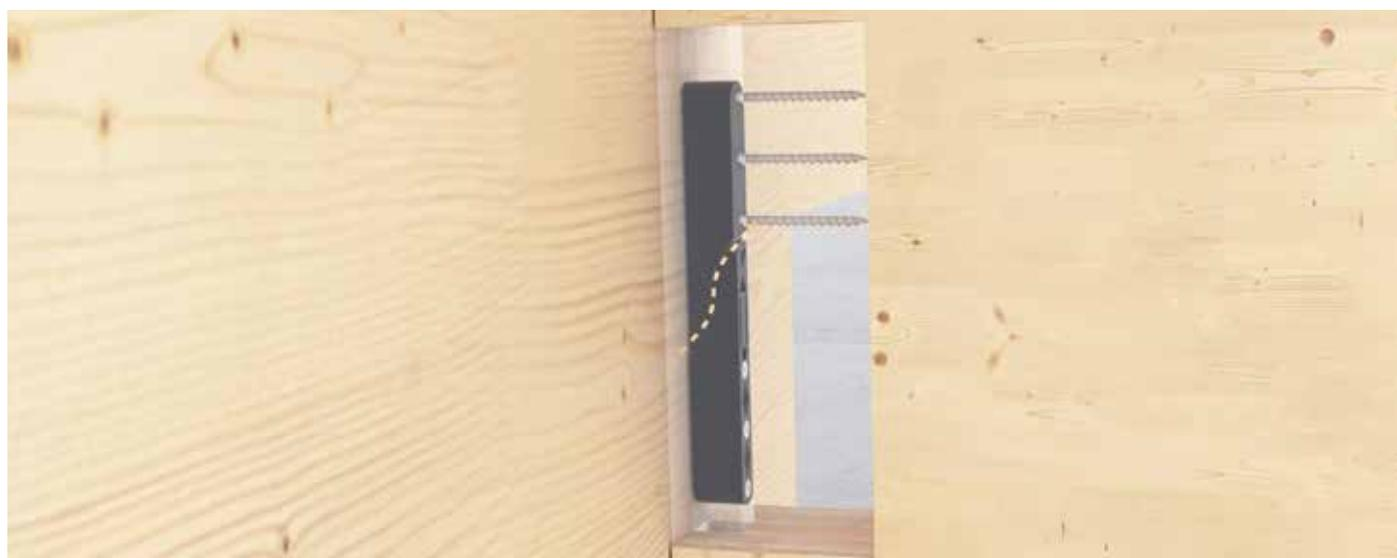
Connecteur de montage, pour monter une paroi sur une deuxième paroi déjà en place.
