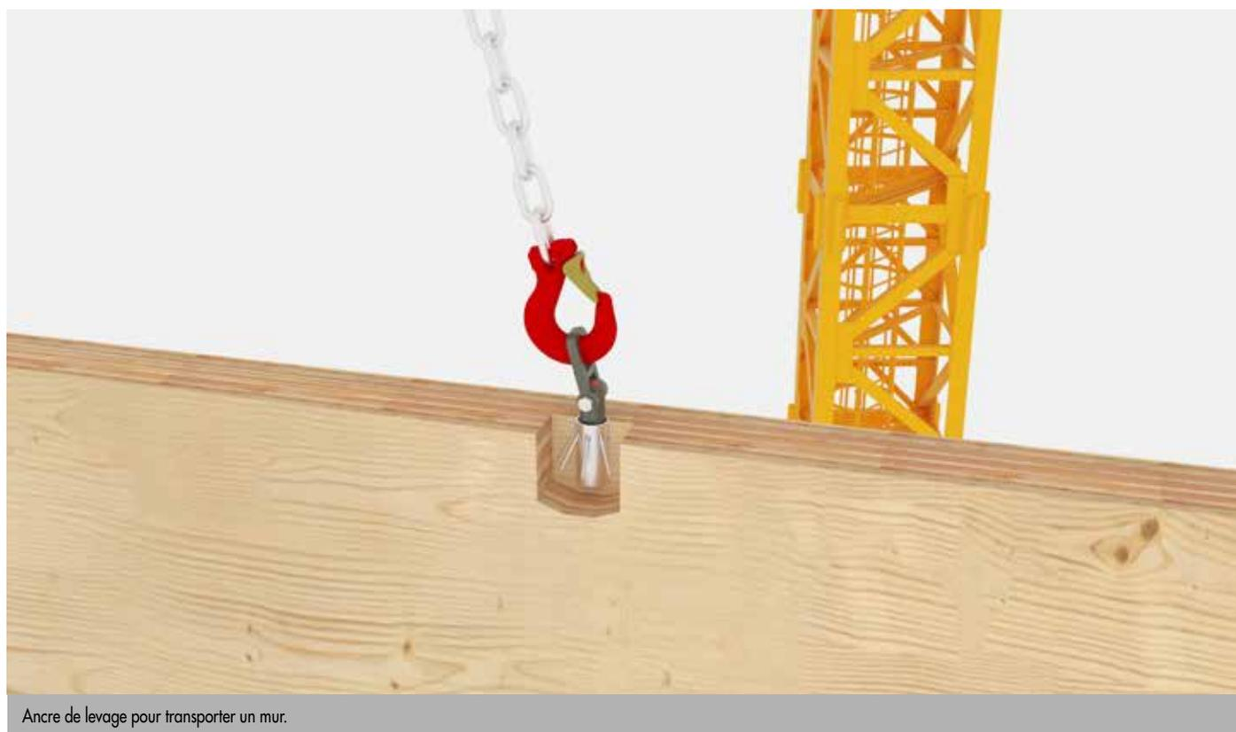
Ancre de levage pour transporter un mur.
