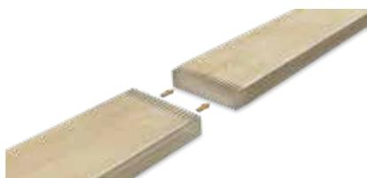
Afin de générer un tronçon de planches de bois pratiquement sans fin, nécessaire pour la fabrication du CLT, on relie entre elles les planches de différentes longueurs. Cette opération s'effectue via un aboutage. On rabote ensuite les planches ainsi obtenues afin d'éliminer les différences d'épaisseur des planches les unes par rapport aux autres.
