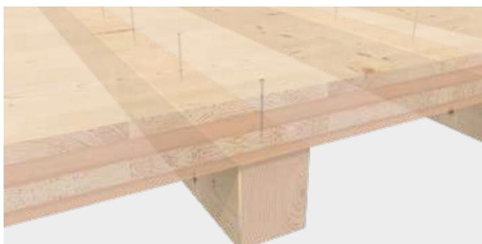
KonstruX DUO pour la fixation d'une poutre
