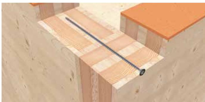
KonstruX pour l'assemblage de deux parois.
