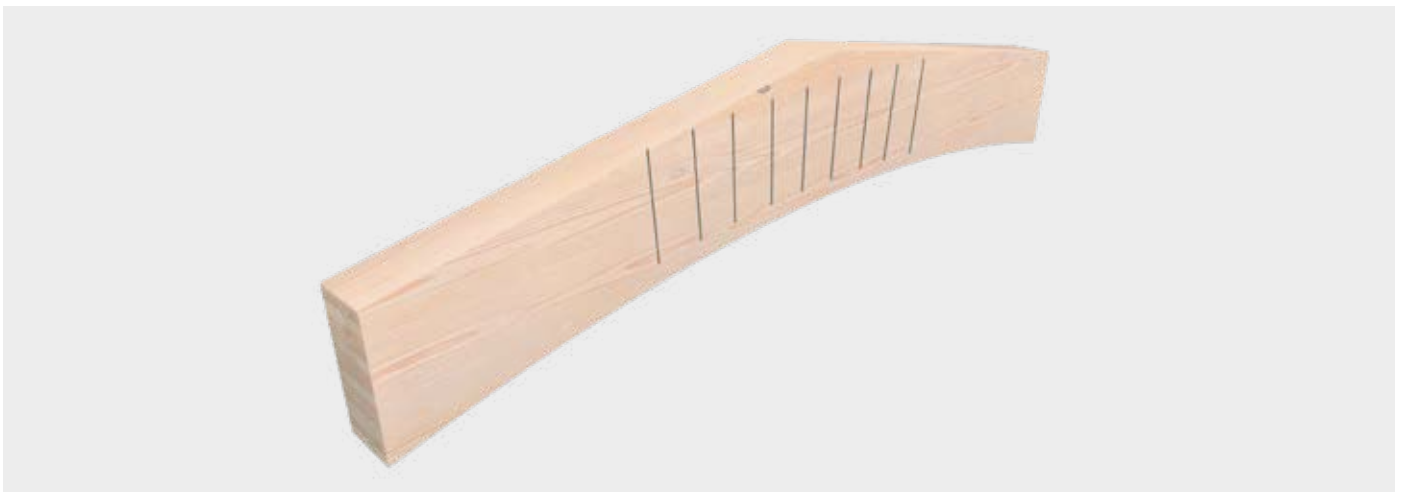
Refuerzo de vigas trapecoidales curvadas
