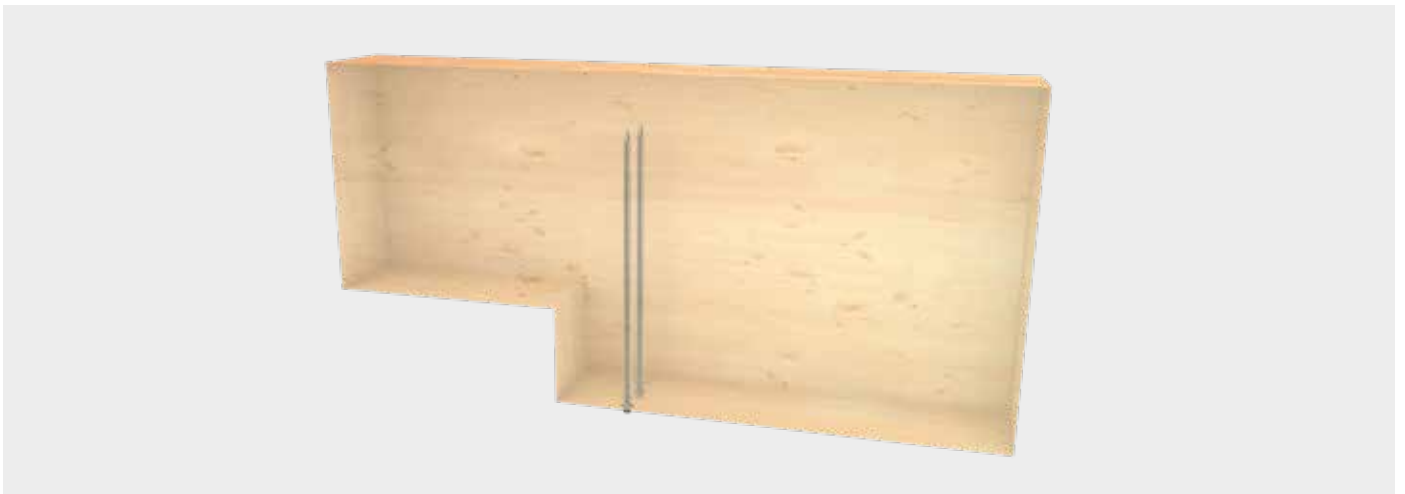
Refuerzo de vigas ranuradas
