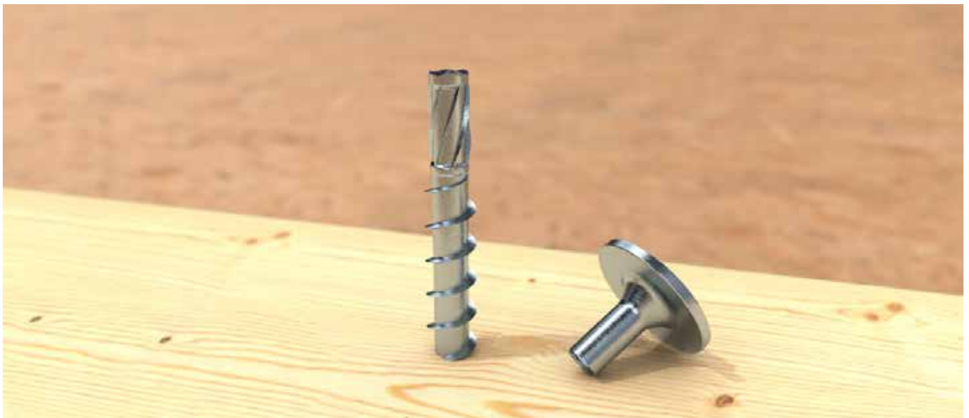
Ergebnis einer abgebrochenen Schraube
