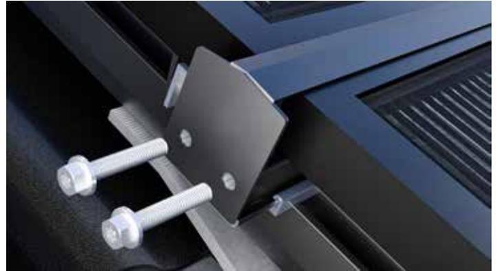
**SCHRITT 25:** Zum Schluss wird die Endkappe auf das Ende der Einlegeprofile gesetzt und mit den Fixierschrauben verschraubt.
