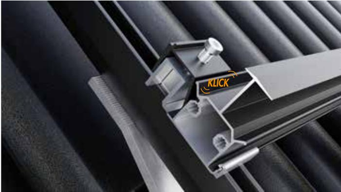
**SCHRITT 13:** Durch Klickfunktion wird das Einlegeprofil mit dem Profilverbinder verbunden. Dadurch kann das Profil nicht mehr herausfallen, aber noch positioniert werden.
