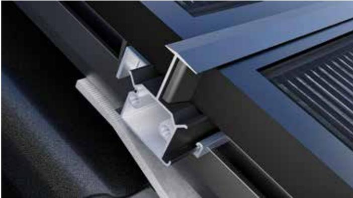
**SCHRITT 24:** Für den Rand brechen Sie die Stifte am Abstandshalter an den Sollbruchstellen ab und klemmen diesen, wie in Schritt 23, hinter das Modul.
