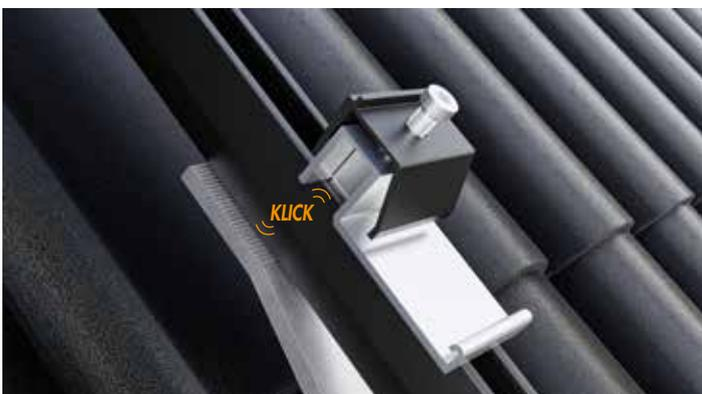
**SCHRITT 11:** Jetzt wird der Profilverbinder nur noch in das Basisprofil eingeklickt. Die Schraube darf hier noch nicht festgezogen werden.
