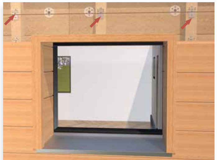
Fassadenprofile direkt über Fenstern und Türen sollten ebenfalls zusätzlich verschraubt werden.
